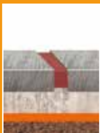
PCI Seccoral 2K Rapid facilite un lit de collage plein
