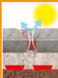
Evaporation et dépôt d'efflorescences sur les joints
