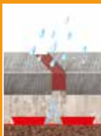
Stockage de l'eau dans les vides
